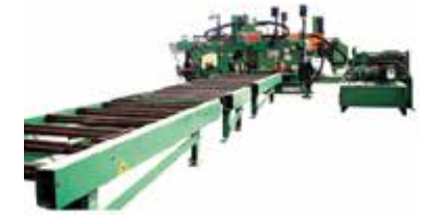
PEDDINGHAUS PCD-1100 Línea de taladro por control numérico.
